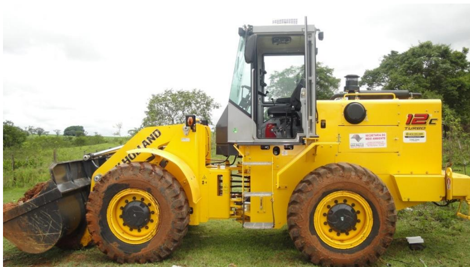
Figura 18: Pá carregadeira utilizada no aterro em valas.
