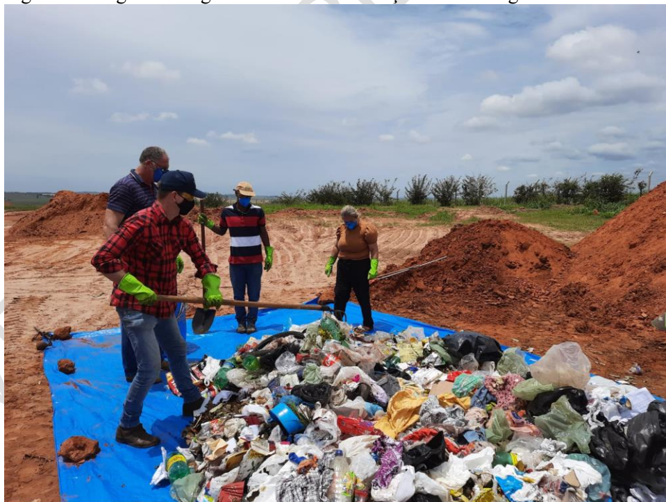
Figura 29: Registro fotográfico durante a execução do estudo gravimétrico.
